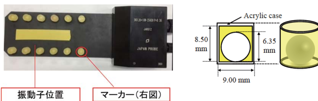
開発した非磁性プローブとMRIマーカ（ジャパンプローブ（株））
