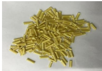
PA66 + アラミド長繊維 (ダイセルポリマー製) 繊維長: 7mm
