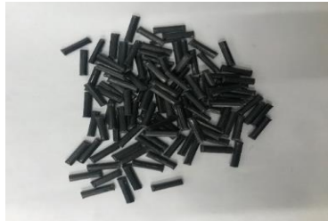
PA66 + 炭素長繊維 (ダイセルポリマー製) 繊維長: 9mm
