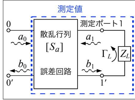
図 5.7. 反射器の接続
