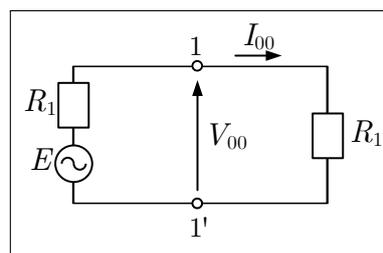
図 1.18. 最大電力が得られる回路
