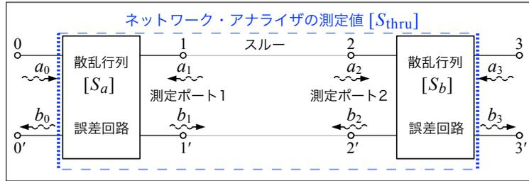
図 5.8. 測定ポートの直接接続（スルー）
