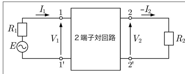
図 1.17. 負荷  $R_2$  で終端した回路
