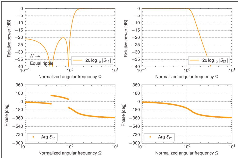
図 8.20. 4 段梯子型回路の 0.04365dB (反射=-20dB) 等リップル低域通過特性 ( $z_{in}^+$ )
