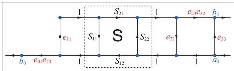
図 5.6. ノードの定義を変更した逆方向シグナルフローグラフ
