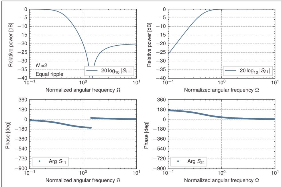
図 8.26. 理想変成器を接続した 2 段梯子型回路の 0.04365dB（反射=-20dB）等リップル高域通過特性 ( $z_{in}^+$ )
