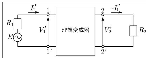
図 1.19. 理想変成器を用いた基準の回路
