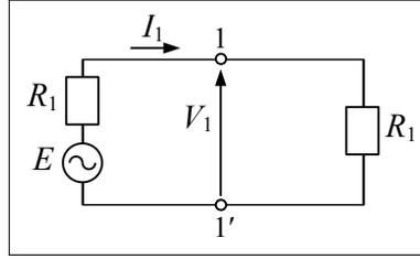
図 6.2. 整合負荷を接続した回路
