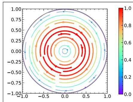
図 3.3. 電界モード関数  $e_{[01]}$  の電気力線
