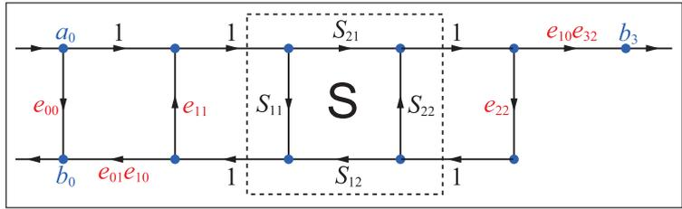
図 5.4. ノードの定義を変更した順方向シグナルフローグラフ
