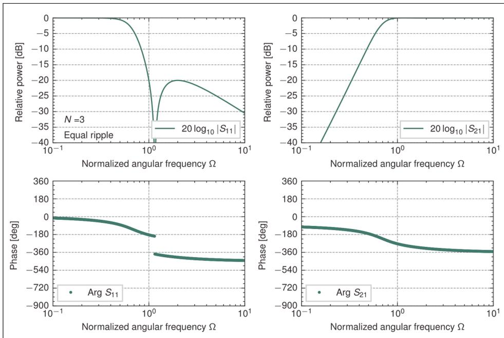
図 8.27. 3 段梯子型回路の 0.04365dB（反射=-20dB）等リップル高域通過特性 ( $z_{in}^+$ )
