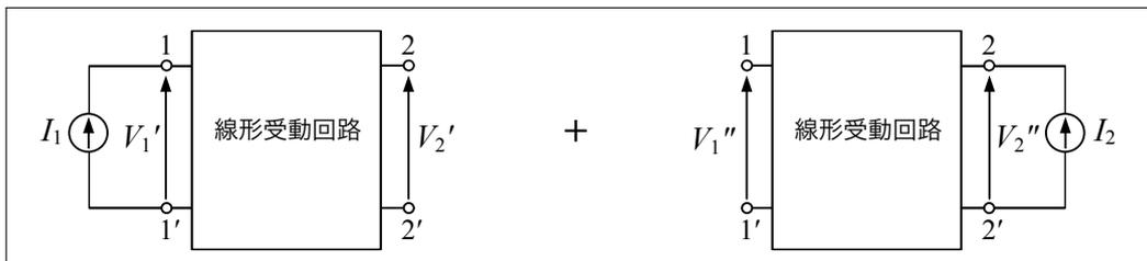
図 1.4. 定電流源を接続した回路
