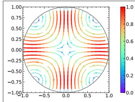
図 3.2. 電界モード関数  $e_{[21]}$  の電気力線
