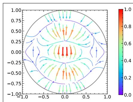
図 3.8. 電界モード関数  $e_{(12)}$  の電気力線
