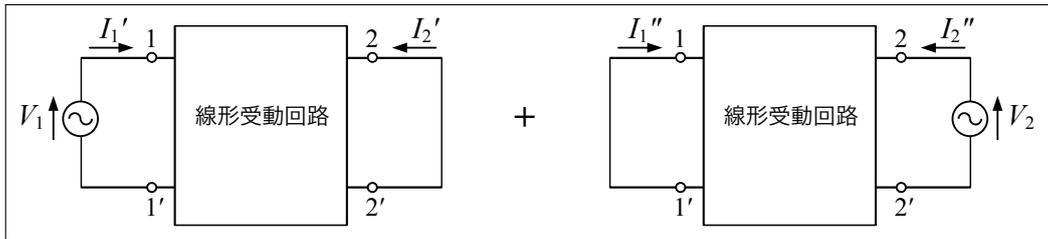
図 1.1. 定電圧源を接続した回路
