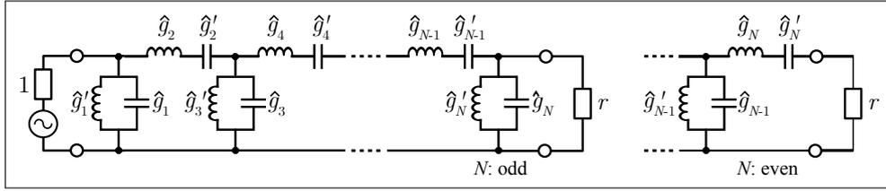
図 7.23.  $z_{in}^-$  により合成した原型低域通過回路を周波数変換した帯域通過梯子型回路
