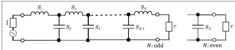
図 7.10. 入力インピーダンス  $z_{in}^+$  により合成した梯子型回路
