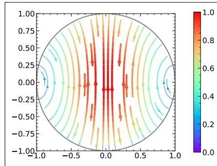
図 3.1. 電界モード関数  $e_{[11]}$  の電気力線
