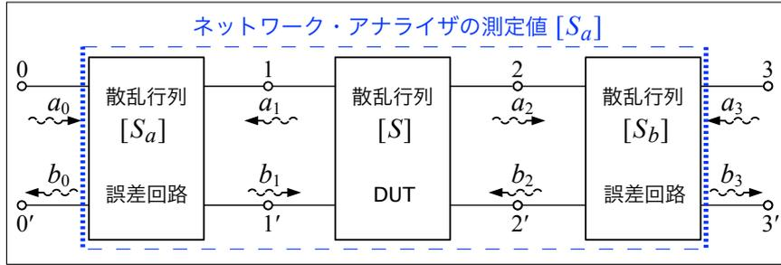
図 5.1. 誤差回路と DUT の縦続接続
