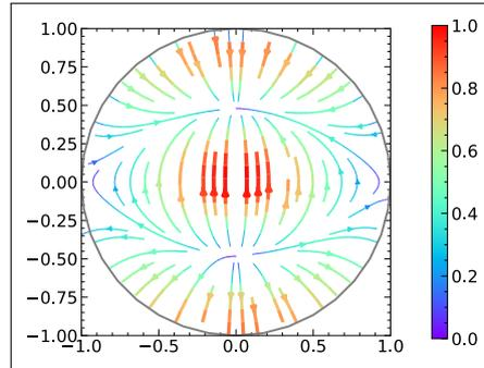
図 3.6. 電界モード関数  $e_{(11)}$  の電気力線
