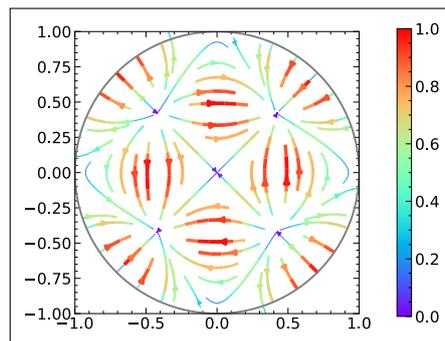
図 3.7. 電界モード関数  $e_{(21)}$  の電気力線
