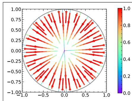
図 3.5. 電界モード関数  $e_{(01)}$  の電気力線
