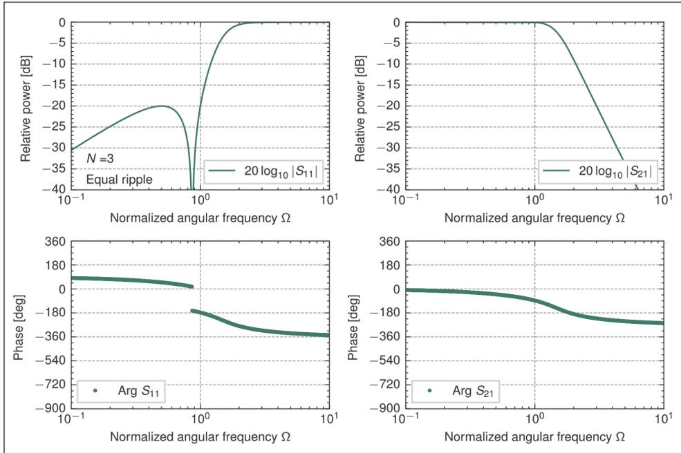
図 8.19. 3 段梯子型回路の 0.04365dB (反射=-20dB) 等リップル低域通過特性 ( $z_{in}^+$ )
