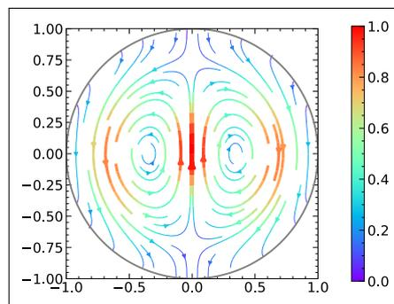
図 3.4. 電界モード関数  $e_{[12]}$  の電気力線
