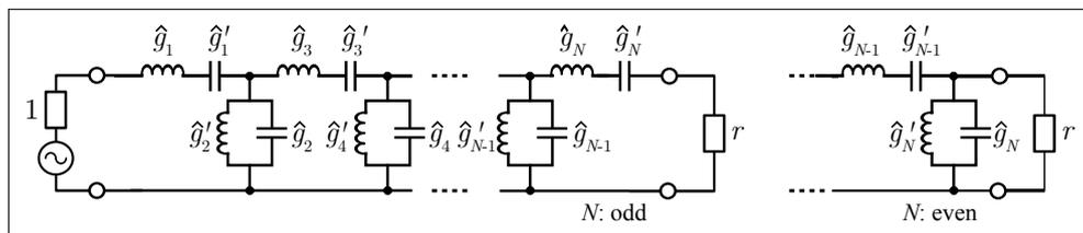
図 7.22.  $z_{in}^+$  により合成した原型低域通過回路を周波数変換した帯域通過梯子型回路
