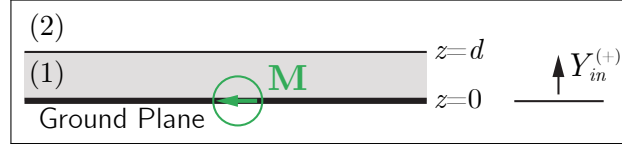
図 2.6. 単層誘電体基板の地導体面に磁流源がある場合
